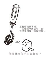
更换好相同型号规格的保险 丝后,重新将保险丝座安装回。
